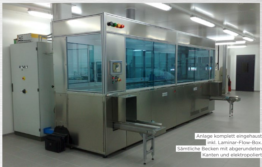
Trockenkammer für zwei Warenkörbe und automat. Schiebedeckel
