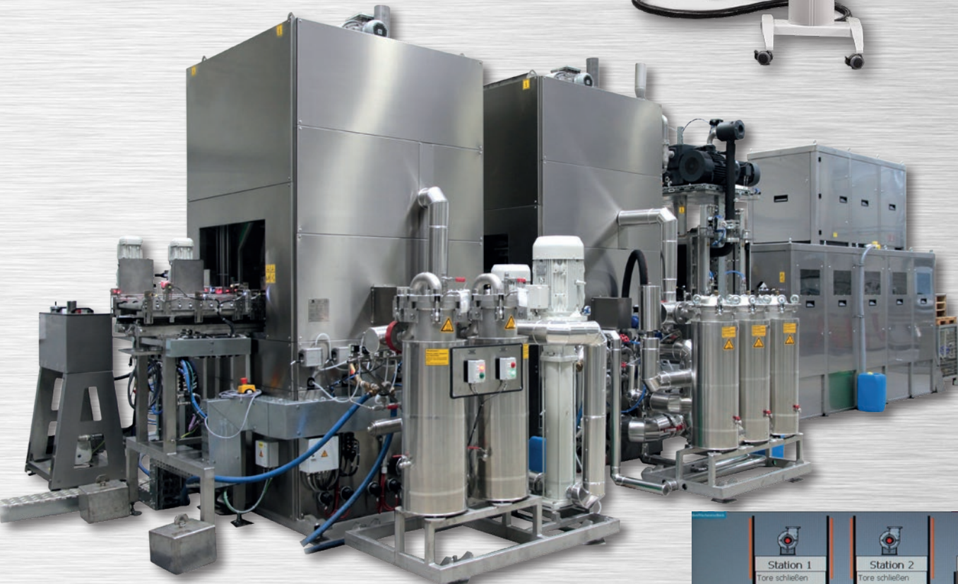
Spritz-Flut-Reinigungsanlage im Durchlaufverfahren
